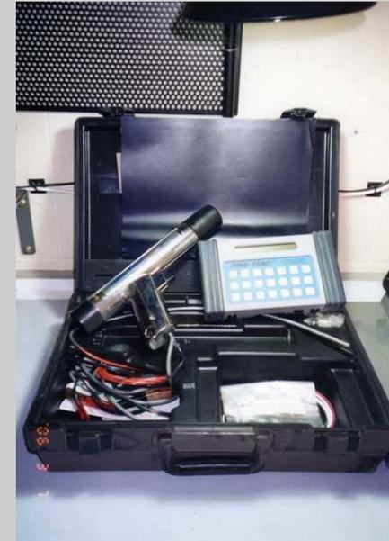
UNICO LABORATORIO EN COLOMBIA CON EL EQUIPO CAM BOX DE CALIBRACION Y DIAGNOSTICO PARA BOMBAS STANADYNE "IFS."
